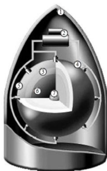
Рис. 1. 2D-зображення схеми ядерної боєголовки (1 — корпус; 2 — вибуховий механізм; 3 — вибухова речовина; 4 — електродетонатор; 5 — нейтронний відбивач; 6 — ядерне пальне ( ^{235}\text{U} ); 7 — джерело нейтронів; 8 — процес стиснення ядерного пального направленим всередину вибухом)
