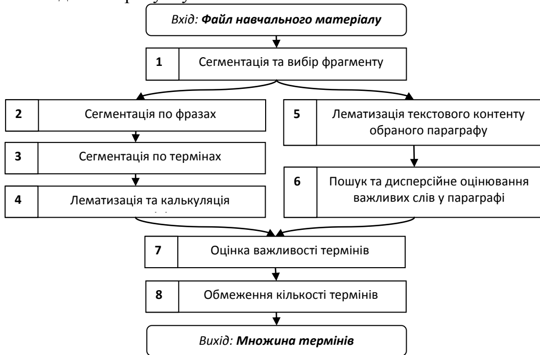
Рис. 1 Схема інформаційної технології автоматизованого множини ключових семантичних термінів
